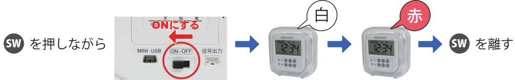
SW を押しながら電源を ON になると LED が白く点灯した後、赤が 1 秒点灯します
